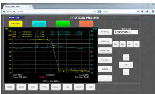
abgesetzter, browsergesteuerter Betrieb per LAN oder separatem WLAN Router
