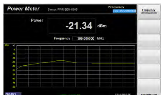
Messen der Sendeleistung von analogen und digitalen Funkgeräten. Hier : analoge Leistungsmessung
