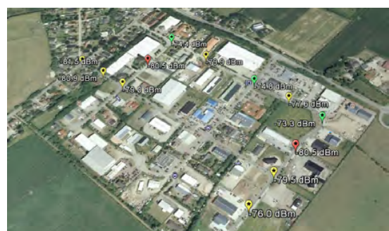
Darstellung der gemessenen Feldstärke in Google Maps, je nach Feldstärke in unterschiedlichen Farben
