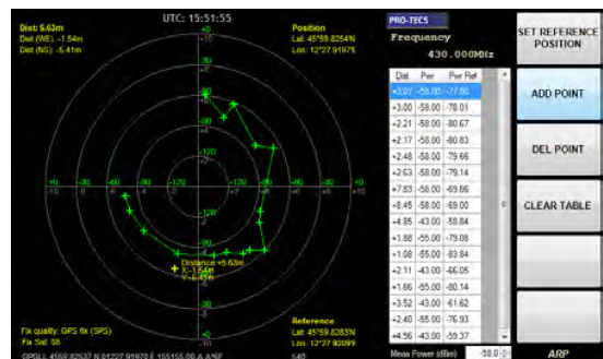
Messen von Antennenabstrahlung Erstellen von Abstrahldiagrammen
