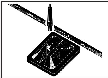
4. Deckel aufsetzen und festdrücken. Jetzt kann der Antennenstrahler montiert werden.
