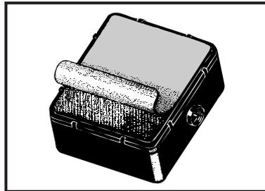
5. Entfernen Sie die Schutzfolie von der inneren Anpasseinheit.
