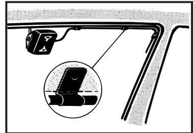
6. Innere Anpasseinheit positionieren und festdrücken. Kabel mit den beiliegenden Clips befestigen.
