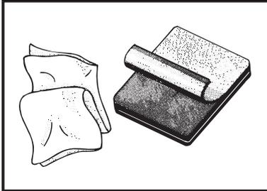
1. Reinigen Sie an der Windschutzscheibe die Montagestelle für den Antennenfuß sowie für die Anpasseinheit und entfernen Sie die Schutzfolie von Antennenfuß.
