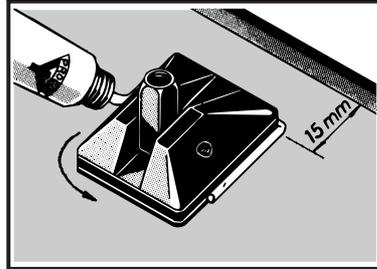
2. Fuß auf die Scheibe aufsetzen und festdrücken. Tragen Sie etwas Kleber entlang des Randes zwischen Fuß und Scheibe auf.
