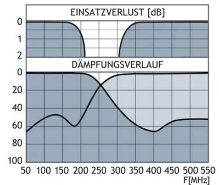
Der PRO-DIPX 175/380... ermöglicht den Betrieb von zwei Sender/Empfängern (je einer pro Frequenzbereich) an einer gemeinsamen Antenne. Siehe untere Skizze.
